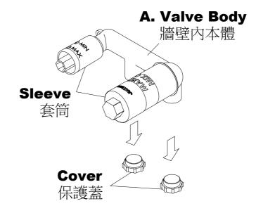
\* Remove the **Covers** of cold and hot inlets before installation. 安裝前請先移除冷熱水進水口保護蓋。
